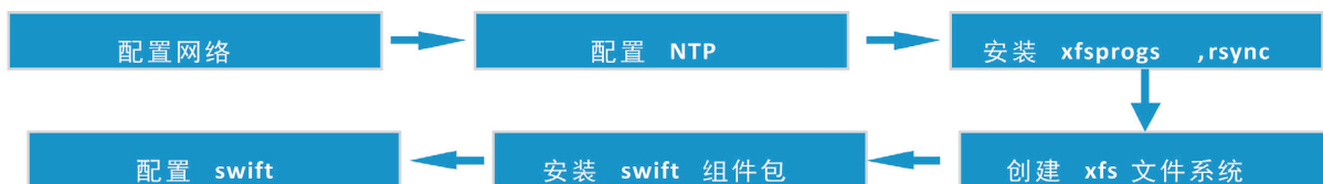
图 3 存储节点安装步骤图
