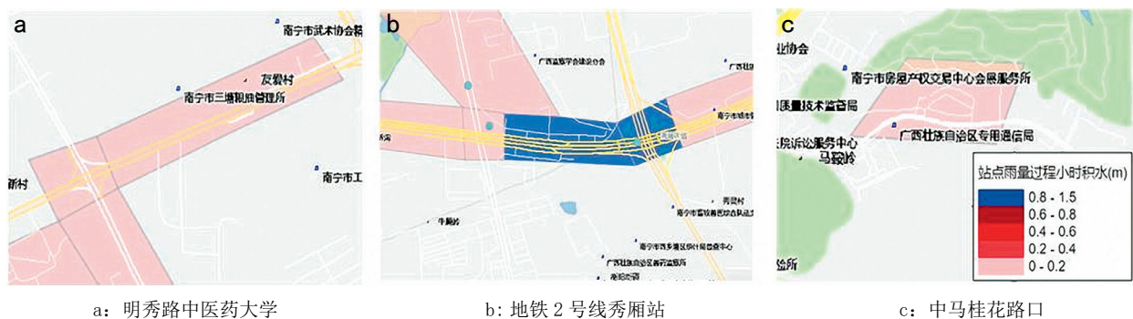
图 3 内涝点小时积水模拟结果
