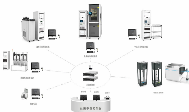
图1 市级区域自动气象站校准系统组成图
