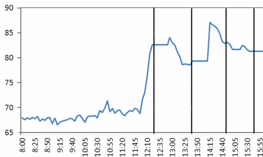
图 4 10 日东莞国家基本站微波辐射计 IWV 值日变化 曲线代表 IWV 值,直线代表一次强降水回波开始时刻
